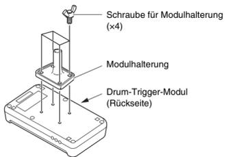
2. Stecken Sie die Modulhalterung in die Halteklemme und ziehen Sie die Ankerschraube fest, um die Modulhalterung in ihrer Position zu fixieren.
