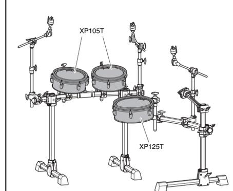
1. Montieren Sie die Tom-Halterung (x 3) auf dem elektronischen Schlagzeug-Rack, wie oben gezeigt, und ziehen Sie dann die Ankerschraube fest, um den Halter an Ort und Stelle zu befestigen.
