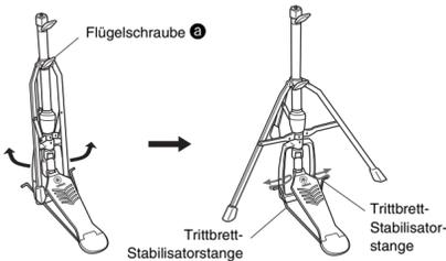
5. Lösen Sie die Flügelschraube **Ⓐ**, um die Hi-Hat-Kupplung zu entfernen.
