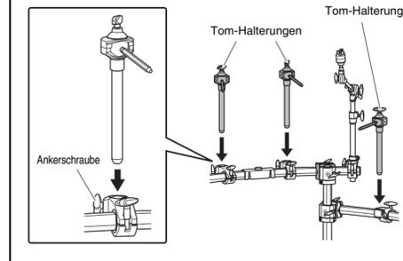
2. Schieben Sie die Tom-Pads auf die Stangen an der Halterung. Lassen Sie einen Abstand von etwa 1,3 cm zwischen der Basis der Tom-Halterung und dem Tom-Pad, und ziehen Sie dann die Flügelschraube fest, um das Pad an Ort und Stelle zu sichern.
