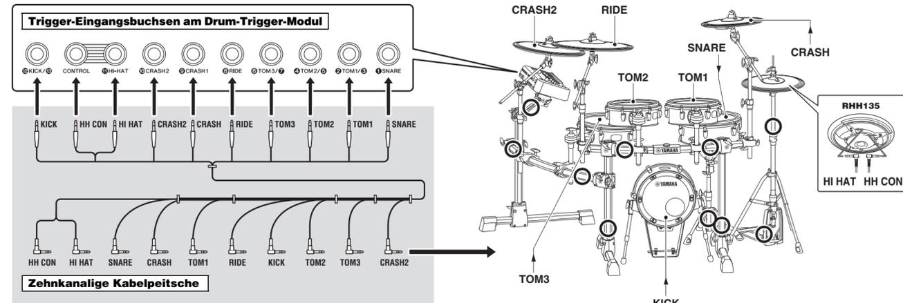
4. Sichern Sie die Kabel mit den Kabelbindern am Rack des elektronischen Schlagzeug-Sets an den in der Abbildung rechts mit Kreisen markierten Stellen. (○)
