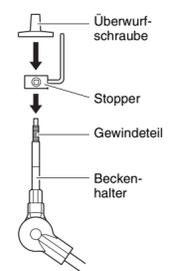
5. Ziehen Sie, während wie unten gezeigt der Stopper vollständigen Kontakt mit der Unterseite der Überwurfschraube hat, die Schüsselschraube des Stoppers mit dem Stimmschlüssel fest.
