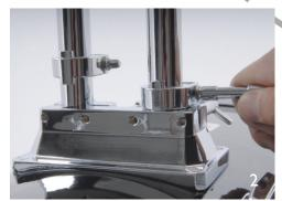
Foto 3:Al final se colocan los timbales. El timbale I tiene un diámetro menor y se instalará en el lado izquierdo.
