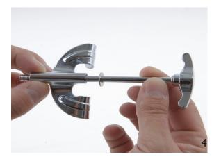
Finalmente toma las varillas tensoras e introduce en ella una arandela y a continuación el soporte de tensión (fotos 3-4), llevandolo seguidamente al borde del aro para fijarlo (fotos 5-6).
