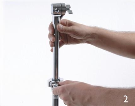
Photo 2: Nous commençons avec le pied perche. Glisse la partie centrale dans le tube et serre avec la vis pour que cela tienne en place.
