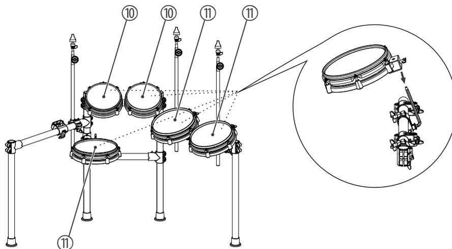
1. ► Befestigen Sie die Befestigungswinkel an den Pads (10, 11). Ziehen Sie die Flügelmuttern an den Pads zunächst handfest an.
