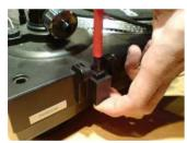
Compressez le ressort à l'aide d'un crayon par exemple (cela demande un peu de force en effet, les ressorts vont devoir supporter le poids du couvercle).
