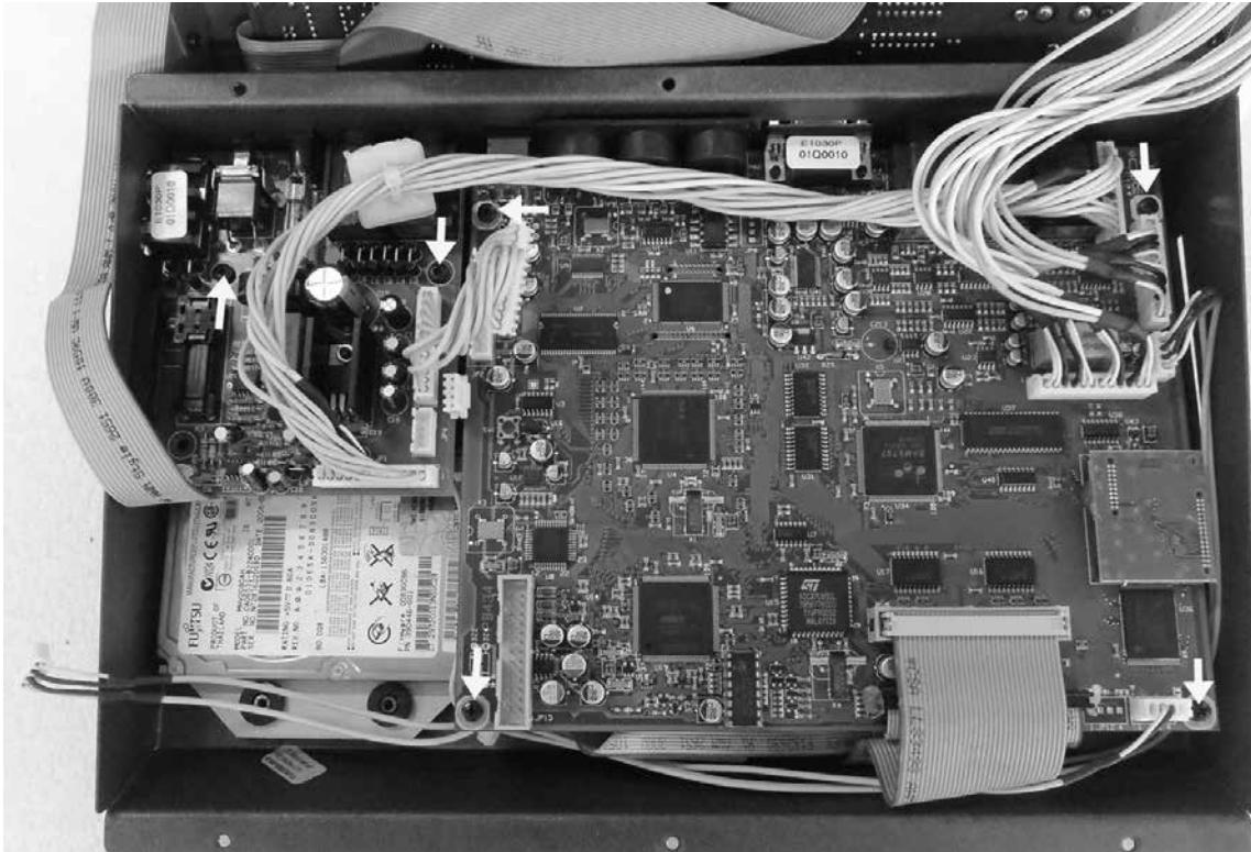
4. Svitare le 4 viti di fissaggio della CPU e le 2 viti di fissaggio dell'alimentatore.
