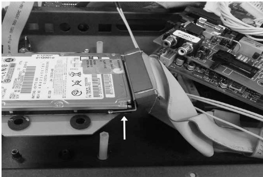
7. Sollevare l'hard disk, sfilarlo dalla sede e scollegare il connettore allargando contemporaneamente le due alette dello stesso connettore.
