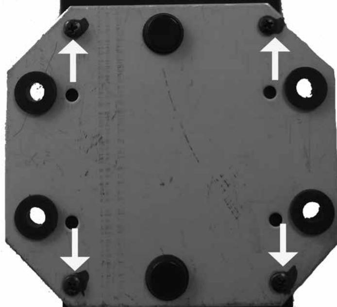
10. Posizionare e avvitare il supporto sulla SSD nuova facendo attenzione a non spostare le rondelle posizionate precedentemente.
