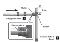
Als allgemeine Regel können Sie definieren: Stecken Sie das gebogene Rohr soweit hinein, bis das Führungsloch in der Aussparung der Halterung zu sehen ist. Ziehen Sie dann den Bolzen mit dem Stimmschlüssel fest.
