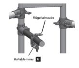
6-4. Stecken Sie die Pad-Halterung mit der Auflage in die Halteklammer und ziehen Sie diese mit der Flügelschraube fest.
