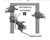
6-5. Stecken Sie die Pad-Halterung in die Halteklammer und ziehen Sie diese mit der Flügelschraube fest.
