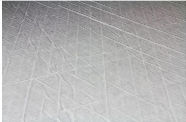
En raison du processus de fabrication, il peut arriver que le film support et sa couche de colle dépassent légèrement des bords de la mousse. Des plis occasionnés par le transport ou le stockage peuvent également apparaître sur le film support.
