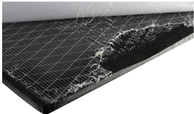
Wird die Trägerfolie nun unvorsichtig oder zu schnell abgezogen, kann es passieren, dass die Klebstoffschicht stellenweise an der Trägerfolie haften bleibt und vom Schaumstoff abgezogen wird.
