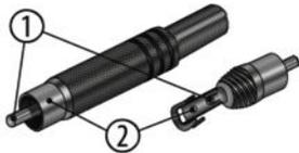
La siguiente ilustración y la tabla muestran la asignación de los pins de un conector tipo Cinch.
