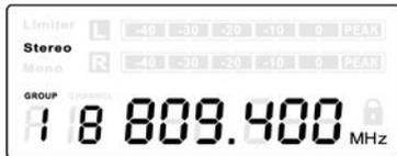
Drücken Sie so oft [SET], bis im Display das Feld „Stereo“ oder „Mono“ blinkt. Benutzen Sie die Tasten ▲ bzw. ▼, um zwischen Mono- und Stereobetrieb umzuschalten. Wenn der gewünschte Modus angezeigt wird, drücken Sie [SET], um die Einstellung zu bestätigen und zum nächsten Menüpunkt zu kommen.
