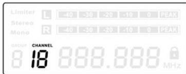
Drücken Sie so oft [SET], bis im Display das Feld „CHANNEL“ (Kanal) blinkt. Benutzen Sie die Tasten ▲ bzw. ▼, um den angezeigten Wert zu erhöhen bzw. zu verringern. Wenn der gewünschte Wert angezeigt wird, drücken Sie [SET], um die Einstellung zu bestätigen und zum nächsten Menüpunkt zu kommen.
