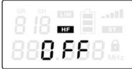
Pulse la tecla de *[SET]*, hasta que el símbolo de "ON" o "OFF" y el campo de "HF" aparezcan parpadeando en el display. Pulse la tecla de ▲ o ▼ para activar o desactivar la función ("ON" o "OFF"). Activando esa función, se aumentan 6 dB las frecuencias del rango alto a partir de 10 kHz, mostrando el display el campo de "HF".
