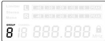
Pulse la tecla de *[SET]*, hasta que el campo de "GROUP" (grupo de frecuencias) aparezca parpadeando en el display. Aumente o disminuya el valor indicado por medio de las teclas de ▲ y ▼. Confirme el valor ajustado, pulsando la tecla de *[SET]*. Al mismo tiempo, se abre el siguiente submenú.
