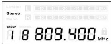
Pulse la tecla de [SET], hasta que el campo de "Stereo" o "Mono" aparezca parpadeando en el display. Pulse la tecla de ▲ o ▼ para cambiar entre los modos de mono y estéreo. Confirme el valor ajustado, pulsando la tecla de [SET]. Al mismo tiempo, se abre el siguiente submenú.
