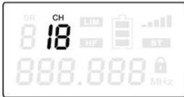
Pulse la tecla de *[SET]*, hasta que el campo de "GROUP" (grupo de frecuencias) aparezca parpadeando en el display. Aumente o disminuya el valor indicado por medio de las teclas de ▲ y ▼. Confirme el valor ajustado, pulsando la tecla de *[SET]*. Al mismo tiempo, se abre el siguiente submenú. Confirme el ajuste, pulsando la tecla de *[ESC]*. Al mismo tiempo, se abre el siguiente submenú.
