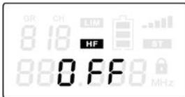
Drücken Sie so oft [SET], bis im Display „ON“ bzw. „OFF“ und das Feld „HF“ blinken. Benutzen Sie die Tasten ▲ bzw. ▼, um die Anhebung hoher Frequenzen ein- bzw. auszuschalten (Anzeige „ON“ bzw. „OFF“). Ist die Funktion eingeschaltet, dann werden die Frequenzen ab 10 kHz um 6 dB angehoben, im Display erscheint das Feld „HF“. Bei deaktivierter Funktion erfolgt keine Anhebung.
