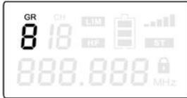
Drücken Sie so oft [SET], bis im Display das Feld „GROUP“ (Frequenzgruppe) blinkt. Benutzen Sie die Tasten ▲ bzw. ▼, um den angezeigten Wert zu erhöhen bzw. zu verringern. Wenn der gewünschte Wert angezeigt wird, drücken Sie [SET], um die Einstellung zu bestätigen und zum nächsten Menüpunkt zu kommen. Drücken Sie [ESC] um die Einstellung zu bestätigen und das Menü zu verlassen.
