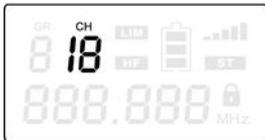
Drücken Sie so oft [SET], bis im Display das Feld „CHANNEL“ (Kanal) blinkt. Benutzen Sie die Tasten ▲ bzw. ▼, um den angezeigten Wert zu erhöhen bzw. zu verringern. Wenn der gewünschte Wert angezeigt wird, drücken Sie [SET], um die Einstellung zu bestätigen und zum nächsten Menüpunkt zu kommen. Drücken Sie [ESC] um die Einstellung zu bestätigen und das Menü zu verlassen.
