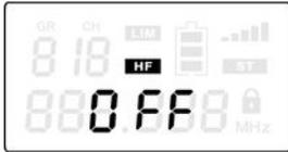
Pulse reiteradamente la tecla de *[SET]*, hasta que aparezcan parpadeando simultáneamente los campos de "ON" o "OFF" y "HF". Pulse ▲ o ▼ para activar o desactivar la función ("ON" o "OFF"). Activando esa función, se aumentan 6 dB las frecuencias del rango alto a partir de 10 kHz, mostrando el display el campo de "HF". Si la función está desactivada, las frecuencias permanecen inalteradas.
