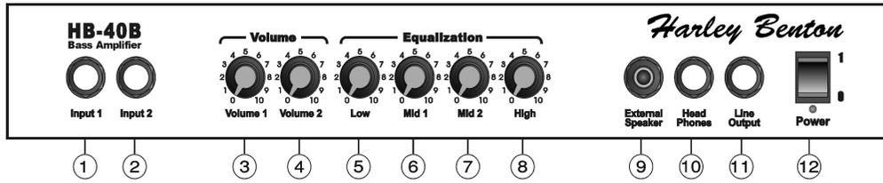
1. Input 1: 6,3mm Klinkenbuchse zum Anschluss von Gitarre, Bass, Keyboard, CD-Player, Kassettendeck, usw. Die Lautstärke wird über den Regler "Volume1" eingestellt.
