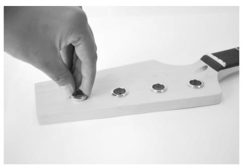
Inserte las clavijas desde la cara posterior del clavijero en los agujeros previstos. Posicione las clavijas en ángulo recto con el borde superior del clavijero.
