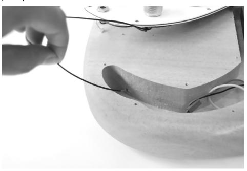
Saque el cable del agujero lo suficiente como para que durante el montaje del puente se pueda producir un contacto suficiente con la superficie metálica. La conexión a tierra de las cuerdas es necesaria para minimizar posibles interferencias (zumbido).
