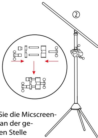
Bringen Sie die Micscreen-Klemme an der gewünschten Stelle am Mikrofonständer an. Fixieren Sie den Haltestab mit dem daran befestigten Micscreen, indem Sie den Haltestab in die Öffnung der Klemme schieben. Arretieren Sie die Teile mit den Metallgriffen der Schraubhalterung.
