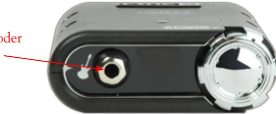
**Instrumenteneingang**—Hier kann eine E-Gitarre bzw. ein Bass angeschlossen werden (dafür benötigst du ein 1/4"-TS-Kabel).
