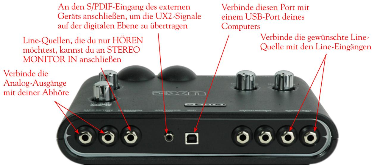
**Line-Eingänge** —Hier kannst du Signalquellen mit Line-Pegel wie z.B. einen Synthesizer, ein Mischpult usw. anschließen.
