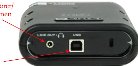
**USB**—Verbinde diesen Port der GX mit einem USB 1.1- oder 2.0-Port deines Computers.
