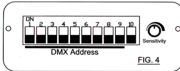
Das Gerät arbeitet mit 6 DMX Kanälen:
