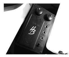
Wechseln Sie die eingesetzte Batterie bei Bedarf (Abschwächung des Ausgangssignals) bzw. in regelmäßigen Abständen aus.
