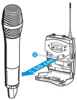
Die Parameter werden auf den Sender übertragen. Wenn die Übertragung abgeschlossen ist, erscheint in der Anzeige des Diversity-Empfängers "√". Danach schaltet der Diversity-Empfänger zurück zur aktuellen Standardanzeige.
