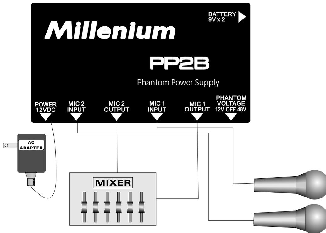
Vielen Dank, dass Sie sich für unseren PP2B entschieden haben. Das Gerät wird Ihnen viele Jahre lang nützliche Dienste erweisen. Es versorgt bis zu 2 Kondensatormikrofone, für deren Betrieb eine Phantomspannung vorgesehen ist. Solche Mikros liefern einen höheren Dynamikumfang, einen geringeren Geräuschpegel und besseren Klang. Die meisten benötigen nur 12 V=, einige aber auch 48V=, was dem alten Standard für Röhrenmikrofone entspricht. Beim PP2B können Sie zwischen beiden Spannungen umschalten.
