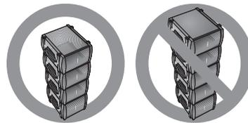
**⚠ ACHTUNG:** Schließen Sie höchstens zwei B1 Bassmodule an den **Bassmodul-Ausgang** am Standfuß an. Wenn Sie mehr als zwei B1-Bassmodule über diesen Ausgang betreiben, wird der Standfußverstärker ungleichmäßig belastet, was die Systemleistung beeinträchtigen kann.
