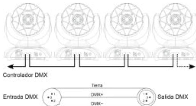
Para asegurar la correcta transmisión de las señales, se recomienda encarecidamente poner una resistencia terminal DMX (120 óhmios, 0,25 W) entre los pines 2 (DMX-) y 3 (DMX+) del cable XLR y seguido al último equipo.
