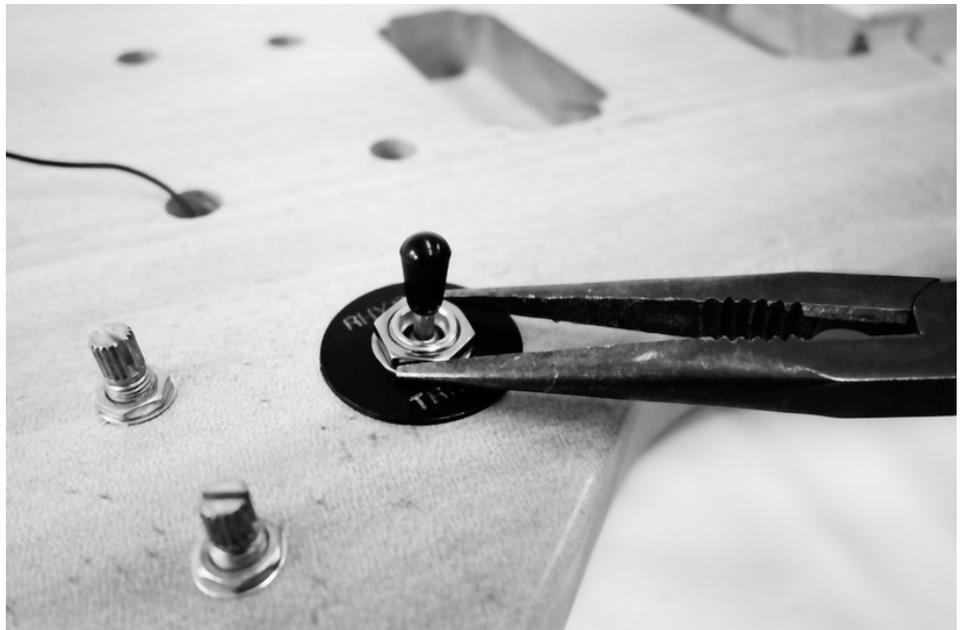
Apriete las tuercas hexagonales de los potenciómetros con una llave poligonal apropiada sobre el cuerpo hasta que la carcasa del potenciómetro ya no se pueda girar.
