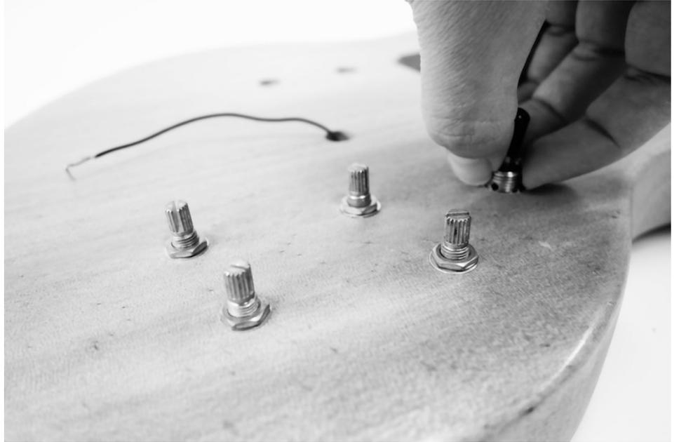
Atornille el interruptor con la tapa de plástico suministrada, una arandela y una tuerca hexagonal al cuerpo. Normalmente, la pastilla del mástil se activa en la posición del interruptor superior y, en la posición del interruptor inferior, la pastilla del puente (en la posición central, las dos pastillas están activas). Este ajuste se puede modificar en todo momento cambiando los conectores.
