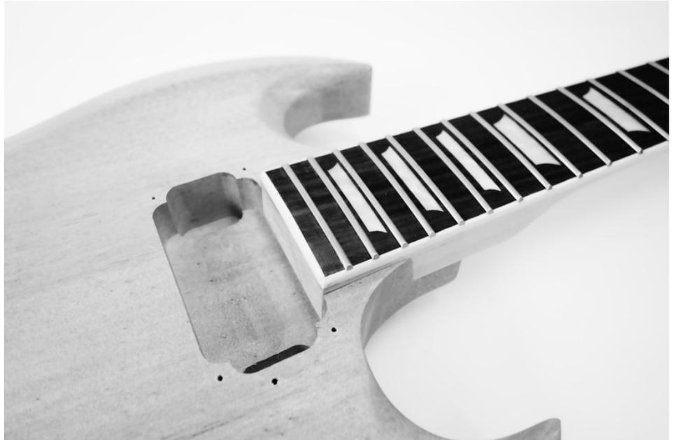
Dele la vuelta a la guitarra, coloque la placa de fijación encima de los cuatros orificios en la parte trasera del cuerpo y atornille el cuerpo y el mástil con los cuatros tornillos largos suministrados.
