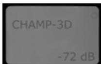
Zeigt den durch den Benutzer definierbaren Text an. Der Default- Text lautet: CHAMP 3D, in Großbuchstaben. Font-Typ und Text können über RS232 geändert werden. Auch der aktuelle Master Level wird angezeigt, hier -72 dB. Drücken Sie den Drucktaster neben dem Pfeil und springen Sie ins Hauptmenu. Das nächste Fenster öffnet sich dann.
