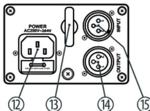
(12) Conector de alimentación y portafusible integrado.
