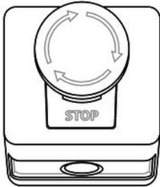
Conecte el interruptor de seguridad adicional (no forma parte del suministro) con el terminal provisto en el equipo. Accionando el interruptor de seguridad conectado, el haz de láser se apagará de inmediato.
