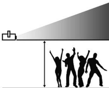
Con el fin de prevenir cualquier tipo de daño personal, es imprescindible respetar todas las normas y reglamentaciones relativas a la mínima altura de montaje para equipos de láser que sean de aplicación en el lugar de uso.
