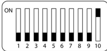
Wenn der DIP-Schalter 10 auf „ON“ steht, arbeitet das Gerät im DMX-Modus und kann von einem DMX-Controller gesteuert werden.
