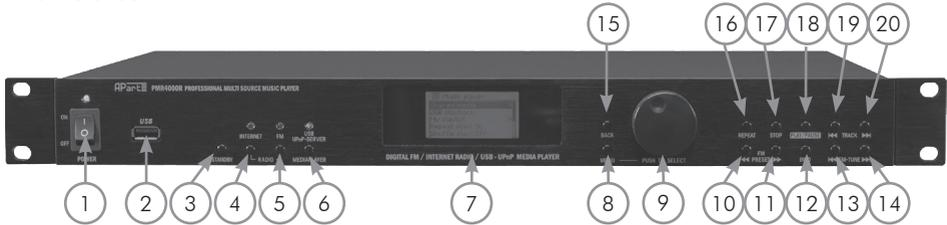
1. Power-Schalter: Schaltet das Gerät ein- oder aus. Im Aus-Zustand ist das Gerät vollständig außer Betrieb. Die Betriebs-LED leuchtet nicht. Während des normalen Betriebs leuchtet sie blau, im Stand-By Modus rot.
