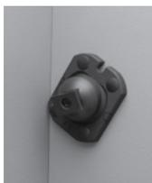
Falls Sie den Lautsprecher unter einem sehr weiten oder schwierigen Winkel installieren müssen, so drehen Sie zunächst die Trägerplatte um 45 oder 90 Grad, um den maximalen Neigungswinkel in die gewünschte Richtung zu bekommen. Eine weitere Methode zum Einstellen eines speziellen Winkels besteht in der 180 Grad Drehung des H-förmigen Hakens.
