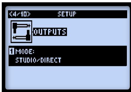
Le bouton 1 sélectionne le **Mode de sortie**. Ce réglage est global.
