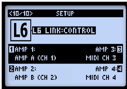
Ces options vous permettent de sélectionner comment connecter un maximum de quatre amplis Line 6 de la gamme DT, chacun “suivant” le modèle et les réglages de l’ampli POD HD Pro X. Les paramètres 1 - 4 correspondent aux amplis DT 1 - 4 connectés par L6 LINK.
