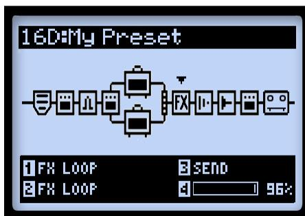
Trajet du signal avec boucle d'effets sélectionnée
