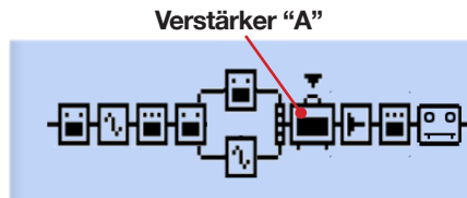
Verstärker in “Post”-Position (hinter Signalweg “A” und “B”)
