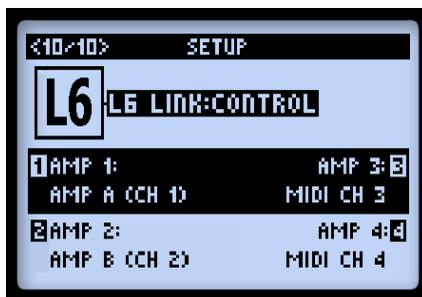
Estas opciones permiten establecer la forma como un máximo de cuatro amplificadores de la serie Line 6 DT conectados “siguen” los ajustes y modelos de amplificador del POD HD Pro X. Los parámetros 1~4 corresponden a los amplificadores 1~4 de la serie DT conectados a L6 LINK, respectivamente.
