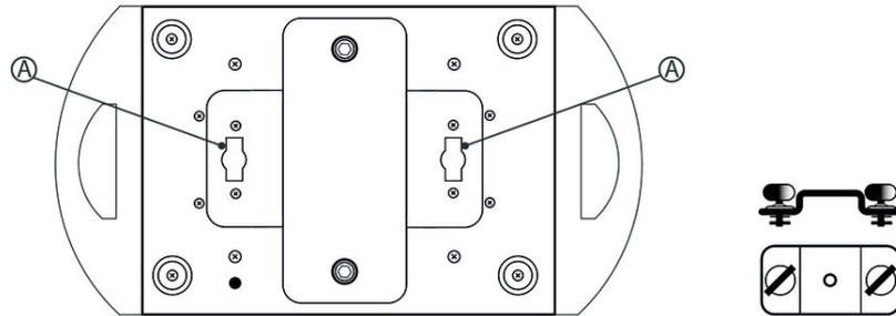
A Schnellverschlussöffnungen für Omega Brackets
