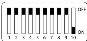
Para controlar las funciones exclusivamente con los interruptores DIP que se encuentran en la cara posterior del equipo, ponga los interruptores 1 a 9 a **[OFF]** y el interruptor 10 a **[ON]**. De esta manera, el equipo funciona en modo continuo, suprimiendo todos los comandos DMX y el telemando. La siguiente tabla muestra los posibles ajustes.
