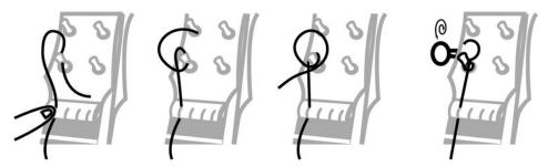
Fädeln Sie die losen Enden der vier Saiten in die Bohrungen der vorgesehenen Stimmmechaniken ein. Achten Sie darauf, jede der vier Saiten mit zwei bis drei Windungen sicher am Stimmwirbel zu befestigen (siehe Abbildung). Spannen Sie alle Saiten zunächst leicht vor und prüfen Sie die Saitenlage wie im folgenden Abschnitt beschrieben.
