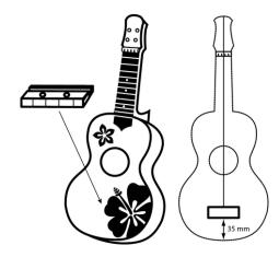
Der Steg wird mittig auf die Korpusdecke geleimt und mit den beiden langen Schrauben fixiert. Markieren Sie zunächst die korrekte Position des Stegs auf der Korpusdecke. Beachten Sie dabei das in der Abbildung angegebene Abstandsmaß.
