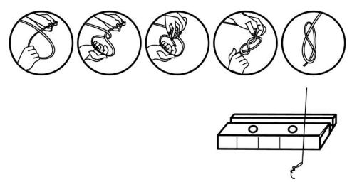
Im Lieferumfang ist ein Satz Saiten für die hawaiische Stimmung (G-C-E-A) enthalten. Verknoten Sie das Ende der Saiten (einfacher Knoten bei den beiden stärkeren Saiten, Doppelknoten bei den beiden dünnen Saiten) und legen Sie die Saiten wie in der Abbildung dargestellt in die Nuten des Stegs:
