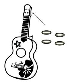
Kleben Sie die vier Fixierringe für die Stimmmechaniken von vorne in die vorgesehenen Bohrungen der Kopfplatte.
