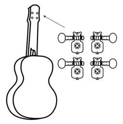
Setzen Sie die vier Stimmmechaniken von der Rückseite der Kopfplatte aus in die vorgesehenen Bohrungen.
