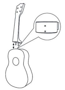
Der Hals wird mit einer Nut-Feder-Verbindung am Korpus befestigt. Prüfen Sie zunächst, ob die Verbindung zwischen Hals und Korpus korrekt passt. Holz verändert im Lauf der Zeit seine Form leicht. Wenn der Hals zu fest in der Nut am Korpus sitzt, kann eine leichte Anpassung mit einem scharfen Stechbeitel oder Schleifpapier erforderlich sein.
