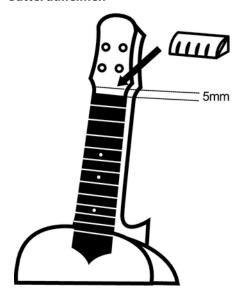
Der Sattel wird oberhalb des Griffbretts auf den Hals geleimt (notwendiger Abstand zwischen Griffbrett und Kopfplatte 5 mm, siehe vorheriger Abschnitt). Tragen Sie Holzleim auf beide Klebeflächen auf. Setzen Sie den Sattel auf den Hals und fixieren Sie ihn zum Trocknen der Klebeverbindung mit Gummiringen am Hals.
