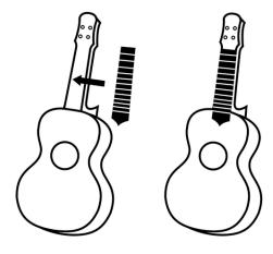
Das Griffbrett wird auf den Hals geleimt. Tragen Sie Holzleim auf beide Klebeflächen auf. Setzen Sie das Griffbrett auf den Hals und richten es so aus, dass am Ansatz der Kopfplatte 5 mm Platz für die Befestigung des Sattels frei bleiben. Fixieren Sie das Griffbrett zum Trocknen der Klebeverbindung mit Gummiringen am Hals.
