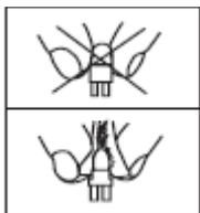
Dieses Gerät ist mit einer Entladelampe ausgestattet, die bei unsachgemäßer Verwendung Schaden nehmen kann. Leuchtmittel nie mit ungeschützten Fingern berühren, da die öligen Ausscheidungen der Haut die Lebensdauer der Lampe verkürzt. Achten Sie auch darauf, dass Sie das Gerät nicht bewegen, bevor die Leuchtmittel nicht abgekühlt ist. Beachten Sie, dass Leuchtmittel nicht unter diese Garantiebestimmungen fallen.
