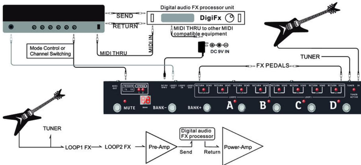
Conectando un instrumento con la entrada *[IN]* y un amplificador con la salida *[LOOP2 OUT]*, se pueden integrar ocho efectos en el circuito de señal. En el ejemplo, se controla un procesador audio que se encuentra detrás de la etapa de entrada en el circuito de señal por medio de otro equipo ajeno.
