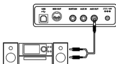
Por medio del terminal [AUX OUT], Vd. puede conectar un amplificador, otros equipos de audio, un mezclador o un equipo de grabación con el piano digital. Conecte el terminal [AUX OUT] del piano por medio de un cable adecuado con la entrada del equipo externo.
