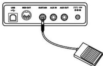
Por medio del terminal de conexión [SUSTAIN], Vd. puede conectar un pedal de sostenido al piano digital.
