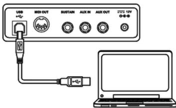
1. ➤ Conecte la conexión USB del piano digital con la conexión USB de su ordenador mediante un cable USB estándar (no incluido en la entrega).
