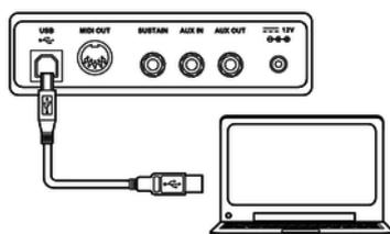
Por medio de la conexión USB, Vd. puede conectar el piano digital con un PC para intercambiar datos.
