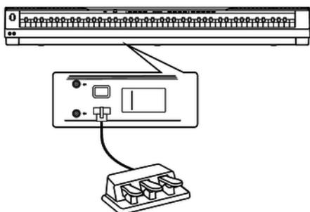
Por medio del terminal de conexión de la parte inferior del equipo, Vd. puede conectar un pedal triple (sustain, sostenuto y soft) al piano digital.
