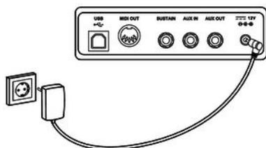
Conecte el cable de alimentación entre la fuente de red y el terminal [12V] en la cara posterior del piano. Conecte la fuente de red con una toma de corriente con puesta a tierra.
