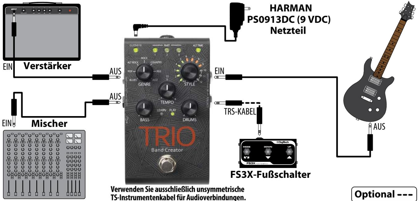
**HINWEIS:** Beim Anschluss an die MIXER- und AMP OUT-Buchsen wird das Gitarrensinal an den AMP-Ausgang gelegt und werden die Bass- und Schlagzeugteile an den MIXER-Ausgang geleitet. Weitere Informationen finden Sie unter „Betrieb der Ausgangsbuchse“ auf Seite 9.
