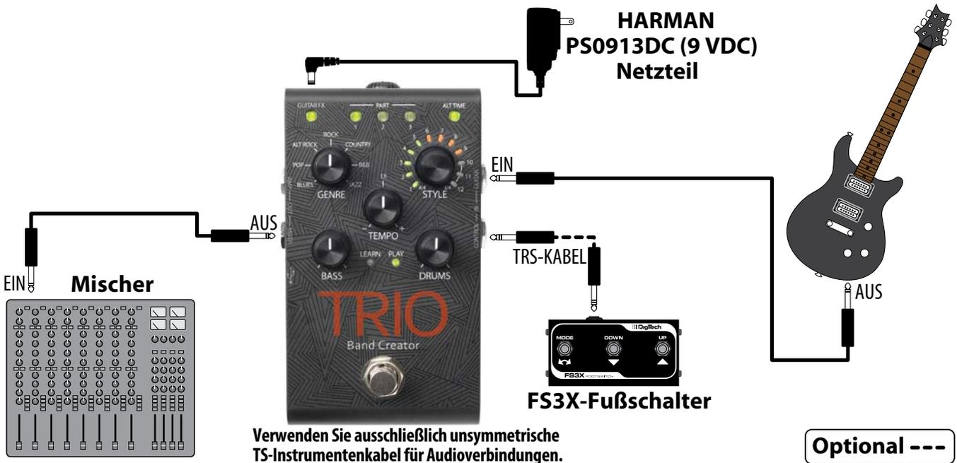
**HINWEIS:** Wenn nur die MIXER OUT-Buchse verwendet wird, wird die Lautsprecherboxemulation dem Gitarrensignal hinzugefügt. Weitere Informationen finden Sie unter „Betrieb der Ausgangsbuchse“ auf Seite 9.
