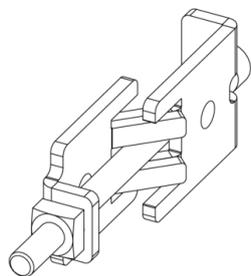
Klappen Sie die Füße (3) vollständig auf und platzieren Sie sie auf einem absolut ebenen, festen und ausreichend tragfähigen Untergrund. Legen Sie die Bühnenpodeste (1) so auf die Füße, das die Oberseite der Füße sich jeweils an den Ecken der Bühnenpodeste befinden. Die Bühnenpodeste müssen auf allen Füßen einrasten.
