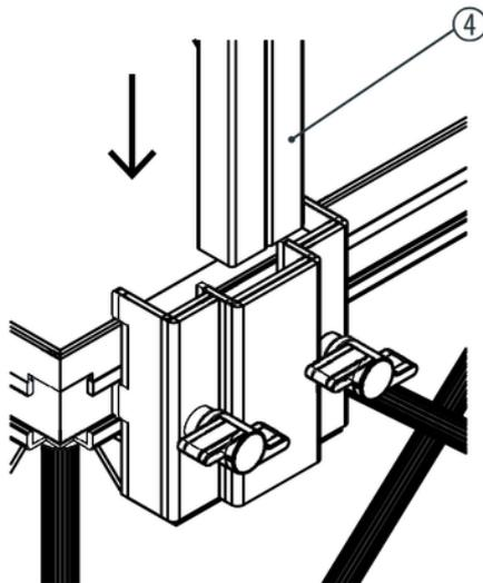
Schieben Sie die Befestigungsklammern (5) für die Geländer (4) in die Profile der betreffenden Bühnenpodeste. Wie in der folgenden Abbildung dargestellt, muss die Führungsnase der Befestigungsklammer im Profil nach oben ausgerichtet werden.
