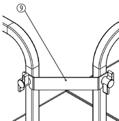
Ziehen Sie abschließend die Knebelschrauben aller Befestigungsklammern fest an. Prüfen Sie den festen Sitz der Geländer.
