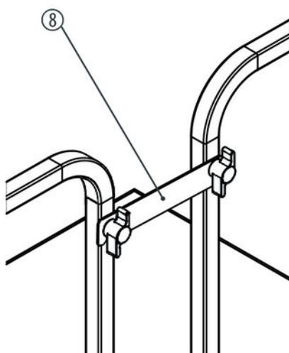
Falls weitere Geländer erforderlich sind, bringen Sie diese zunächst an den Bühnenpodesten an. Verbinden Sie die Geländer anschließend untereinander. Benutzen Sie dazu entweder die geraden Geländerverbinder (8) oder die abgewinkelten Geländerverbinder (9). Ziehen Sie die Knebelschrauben an den Geländerverbindern fest an.
