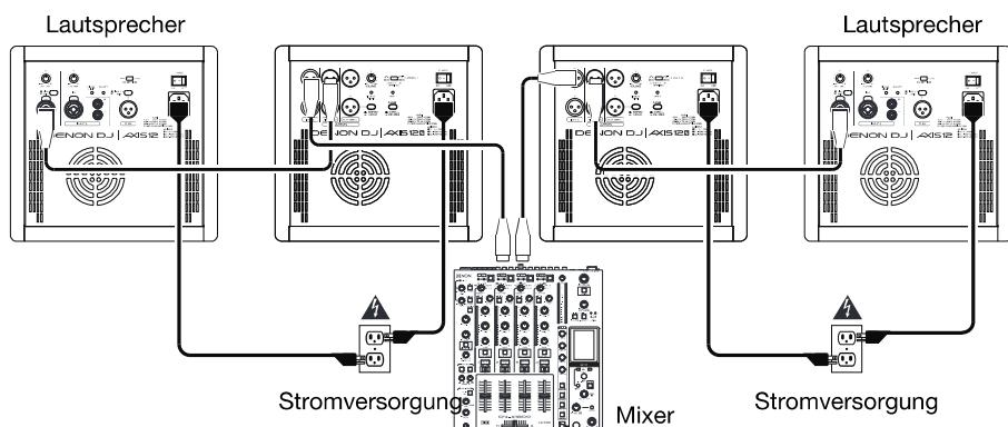
Verbinden Sie die linken und rechten Ausgänge des Mixers über XLR-Kabel mit **Eingang 1** jedes Subwoofers und schließen den **Hochpassausgang** jedes Subwoofers an den Eingang jedes Lautsprechers an.
