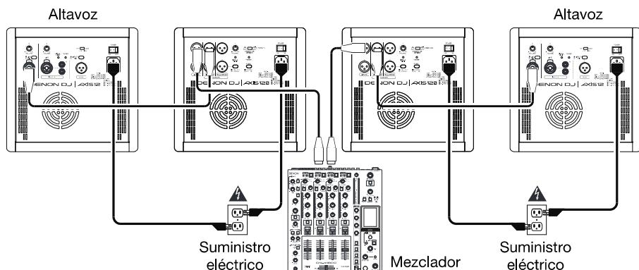
Conecte las salidas izquierda y derecha de su mezclador a la **entrada 1** de cada subwoofer mediante cables XLR, y a continuación, conecte la **salida pasaaltos 1** de cada subwoofer a la entrada de cada altavoz.
