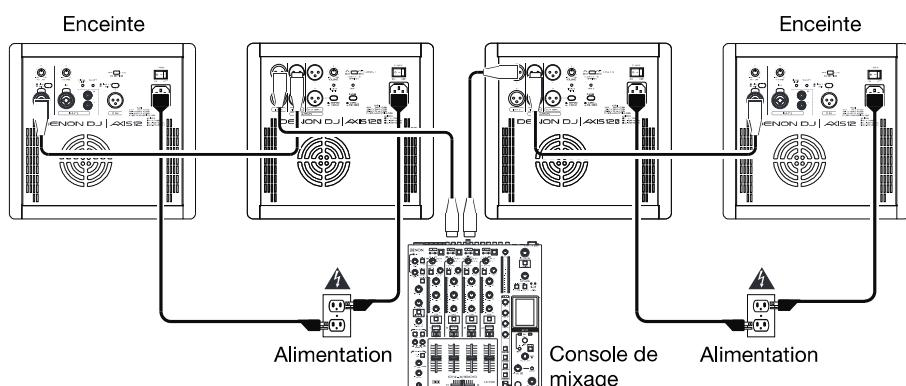
Branchez les sorties gauche et droite de la console de mixage à l'**entrée 1** de chaque caisson d'extrêmes graves, puis branchez la **sortie passe-haut 1** de chaque caisson d'extrêmes graves à l'entrée de chaque enceinte en utilisant des câbles XLR.
