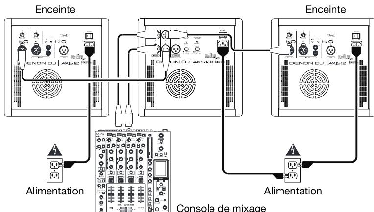
Branchez les sorties gauche et droite de la console de mixage aux entrées du caisson d'extrêmes graves, puis branchez les **sorties passe-haut** du caisson d'extrêmes graves à l'entrée de chaque enceinte en utilisant des câbles XLR.
