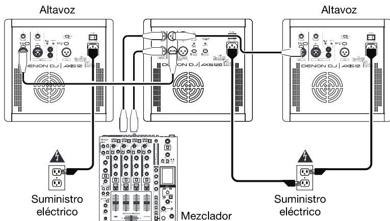
Conecte las salidas izquierda y derecha de su mezclador a las entradas de su subwoofer mediante cables XLR, y a continuación, conecte las **salidas pasaaltos** del subwoofer a la entrada de cada altavoz.
