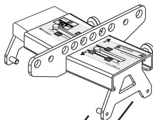
b) Allineare DRK-IG a INGENIA IG4T ed inserire i perni della staffa, (nel lato fissato in posizione IG1T/IG4T) in corrispondenza dei fori dello speaker, come mostrato in figura.
