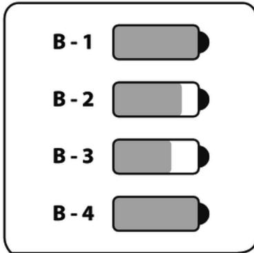
Die Ladezustandsanzeige kann auf dem Gerätedisplay für jeden der vier eingesetzten Akkus abgerufen werden. Die Balkenlänge und die Farbcodierung zeigen symbolisch die verbleibende Ladekapazität. Diese Anzeige erscheint, wenn das Gerät mit Netzspannung versorgt wird und der Netzschalter ausgeschaltet ist.
