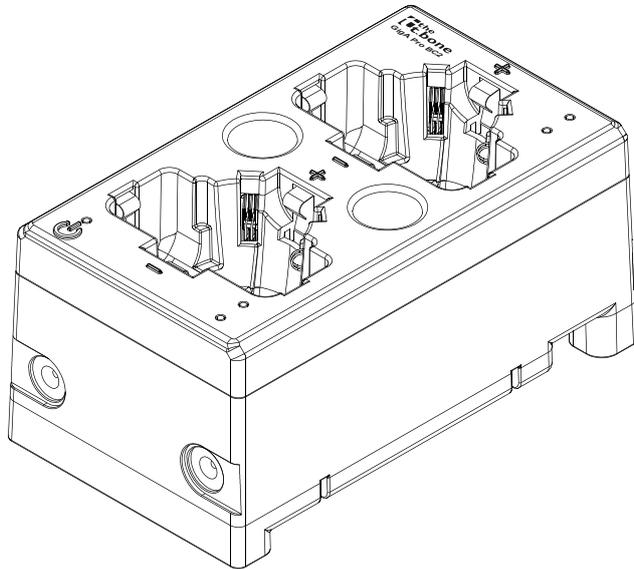
Der GigA Pro BC2 Battery Charger ist eine Akku-Ladestation, die über zwei Ladeschächte verfügt. Jeder Ladeschacht ermöglicht das Laden von
