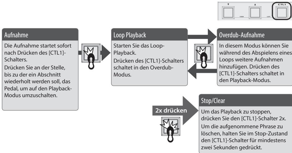
\* Die in den Patches gespeicherten Einstellungen für den [CTL1]-Schalter werden ignoriert, solange der Looper eingeschaltet ist.
