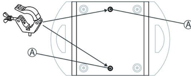
A Mecanismos de cierre rápido para abrazaderas tipo omega bracket
