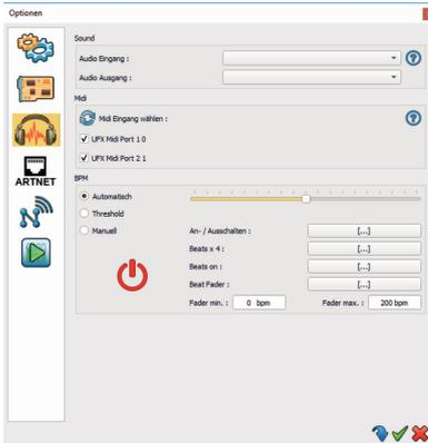
Dieser Abschnitt dient zur Konfiguration der Audio-Ein- und Ausgänge. Falls Sie ein Audio-signal desselben Computers analysieren möchten, können Sie dies intern durchschleifen. Je nach Betriebssystem sind hier unterschiedliche Ansätze möglich.
