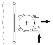
Beim Versand ist die Batterie bereits in die Fernbedienung eingelegt und durch eine transparente Kunststofffolie vor Entladung geschützt. Entfernen Sie die Kunststofffolie vor der ersten Benutzung.
