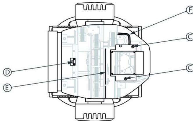
5. ▶ Lösen Sie die beiden Kreuzschlitzschrauben, die die Leuchtmittelabdeckung halten (in der Abbildung durch „C“ gekennzeichnet) und entfernen Sie die Leuchtmittelabdeckung.
