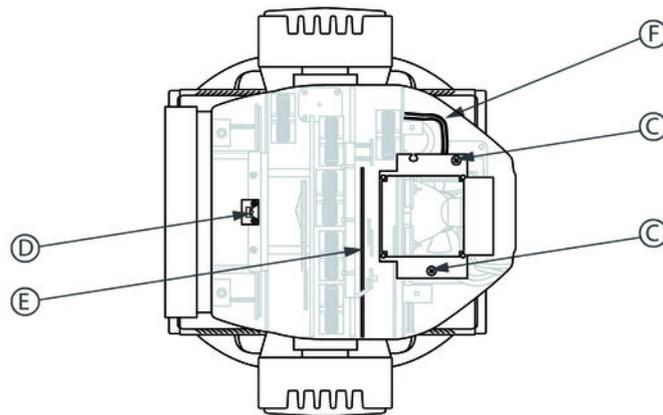
9. ▶ Bringen Sie die Leuchtmittelabdeckung wieder an und befestigen Sie sie mit den beiden Kreuzschlitzschrauben (in der Abbildung durch „C“ gekennzeichnet).
