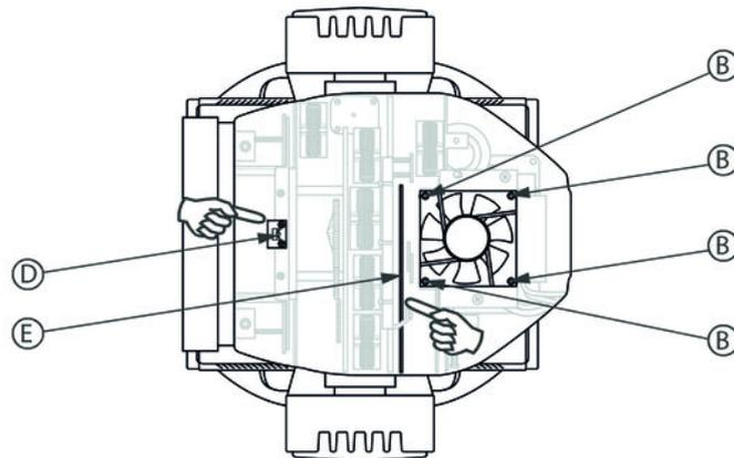
4. ➤ Prüfen Sie, ob Sie die richtige Abdeckung entfernt haben. Vergleichen Sie das freigelegte Geräteinnere mit der Abbildung. Wenn Sie den Hitzesensor (in der Abbildung durch „D“ gekennzeichnet) an dieser Stelle sehen können, wurde die richtige Gehäuseseite geöffnet. Wenn die richtige Gehäuseseite offen ist, können Sie außerdem das Farbrad deutlich sehen (in der Abbildung durch „E“ gekennzeichnet).
