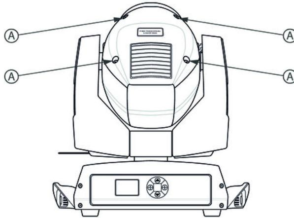
3. ➤ Öffnen Sie das Gehäuse durch Lösen der vier Kreuzschlitzschrauben an der Gehäuseoberseite, die in der Abbildung oben durch „A“ gekennzeichnet sind, und entfernen Sie den oberen Teil des Gehäuses. Achten Sie darauf, dass keine Schraube in das Geräteinnere fällt.
